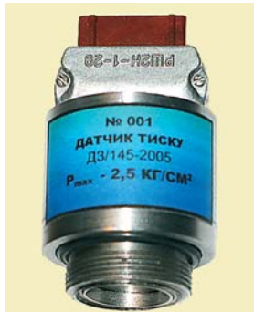
Прецизійний перетворювач тиску — зразок розробок за результатами науково-дослідної роботи кафедри
