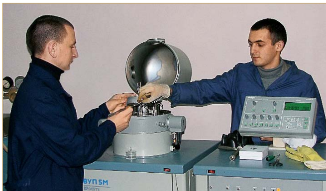
Встановлення зразків у робочий об'єм ВУП-5М-01 для проведення одного з етапів виготовлення контактів методом магнетронного розпилення, м. н. с. С. В. Лукашук (зліва) та м. н. с. В. В. Кусьнеж, 2009 р.
