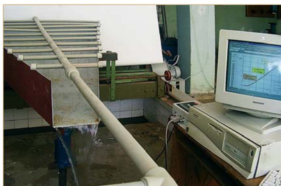
Експериментальна установка для дослідження закономірностей формування дощового стоку в режимі on-line
