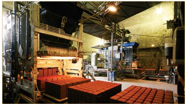
Впровадження технологій ущільнення наджорстких бетонних сумішей для вібропресування фігурних елементів мощення на заводі залізобетонних конструкцій ім. С. Ковальської (Київ)
