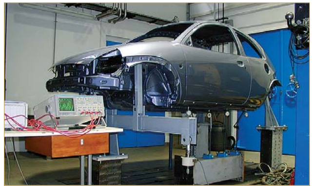
Спільно з німецькими колегами розроблена методика оцінки власних частот кузовів автомобілів
