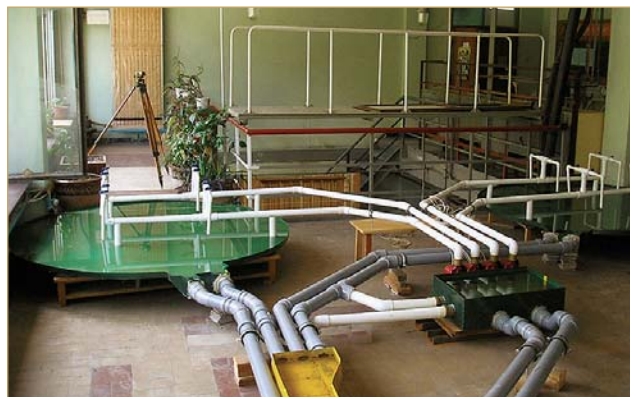
Фізична модель системи оборотного водопостачання АЕС
