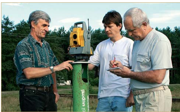
Еталонування ліній взірцевого базису Яворівського наукового геодезичного полігона прецизійним електронним тахеометром Trimble 5601. Зліва направо: доцент О. Денисов, працівник Укрметртестстандарту В. В. Заєць, професор І. Тревого
