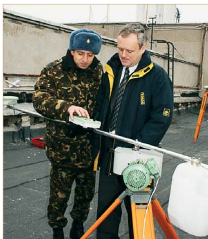
Дослідження похибок GPS-вимірів на кінематичному стенді проводять співшукач Військового інституту майор О. Полець і проф. К. Третяк
