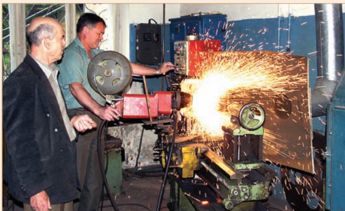
Электродуговая наплавка валков в исследовательской лаборатории кафедры оборудования и технологии сварочного производства
