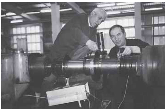
Зміцнення підшипникової шийки електроерозійним легуванням із фінішною обробкою поверхневим пластичним деформуванням
