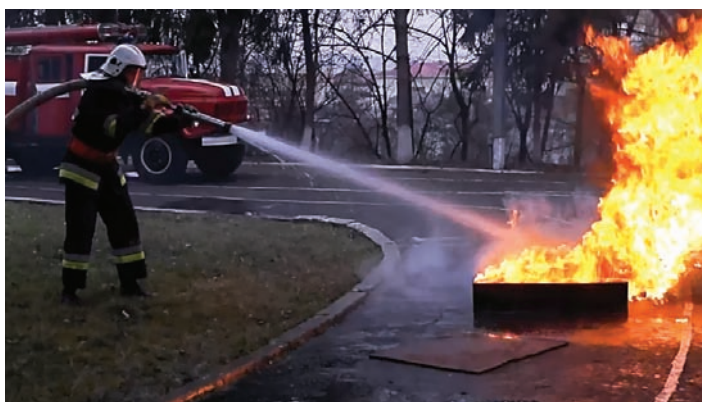
Випробування піноутворювача для пожежегасіння «Барс» на полігоні Львівського державного університету безпеки життєдіяльності
