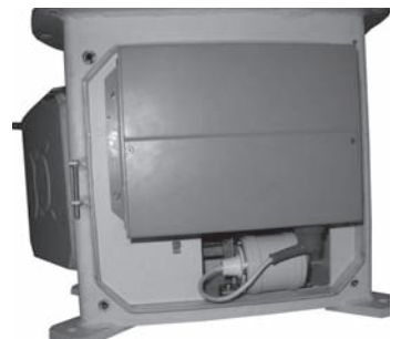
Передавач-РЛС «Буревісник-1, «Буревісник-4» на основі імпульсного магнетрона БУТОН
