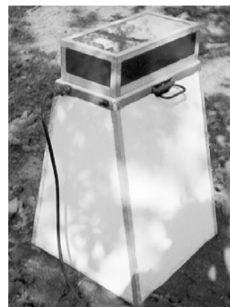
Діючий макет акустичного випромінювача для знищення колорадського жука акустичним способом
